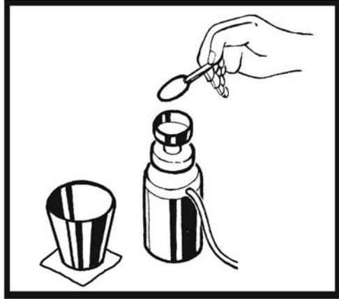
10. Pasar la membrana a la placa de petri, donde previamente se han incorporado una almohadilla y el medio de cultivo. Invertir la placa e incubar. En general, la incubación en los equipos de campo acondicionados para coliformes totales se hace a 35,5 °C y para coliformes termotolerantes y *E. coli*, a 44,5 °C.
