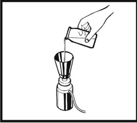
6. Con el fin de controlar la esterilidad del equipo y del medio de cultivo, el resultado de esta placa debe ser negativo. Verter en el embudo 100 mililitros de agua destilada estéril.
