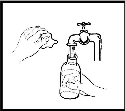
3. Llenar el frasco. Mantener la tapa y la cubierta protectora hacia abajo (para evitar la entrada de polvo portador de microorganismos). Poner inmediatamente el frasco debajo del chorro de agua y llenarlo como se indica en la figura.
