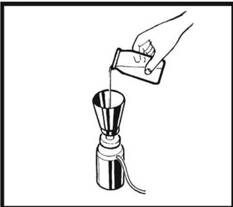
8. Verter 100 mililitros de la muestra en el embudo. Observar las marcas de graduación que figuran en el interior del embudo.
