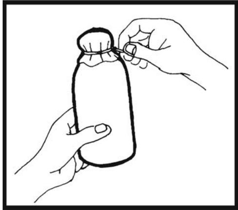
6. Homogeneizar la muestra, agitando un número no menor de 25 veces, inclinando el frasco y formando un ángulo de  $45^\circ$  entre el brazo y el antebrazo.
