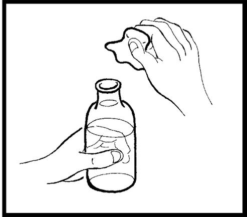
Para las mediciones de pH, cloro residual y turbiedad, seleccionar otro frasco o un vaso de muestreo y enjuagarlo tres veces consecutivas antes de tomar la muestra definitiva. Efectuar el análisis de pH, cloro residual y turbiedad.
