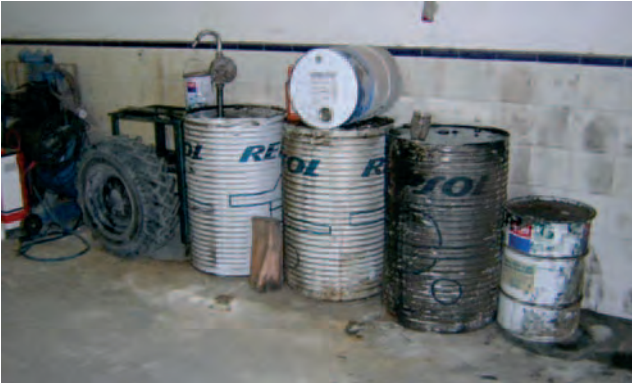
Figura 157. Bidones almacenados sin cubeto de retención con derrames.
