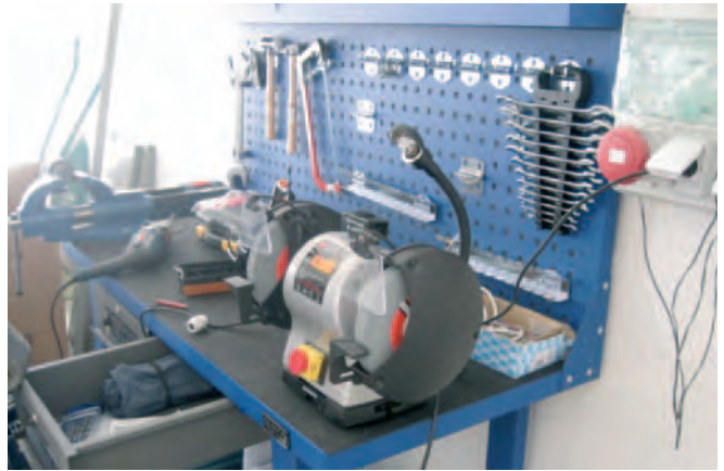
Figura 152. Mesa de trabajo con herramientas, taladro eléctrico manual, amoladora fija de mesa, etc.
