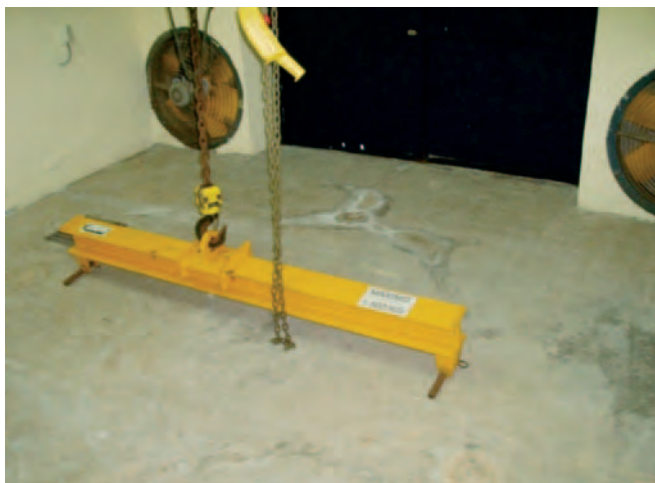
Figura 131. Polipasto para cambio de contenedores.
