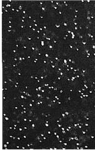
Fig. 111. Tamaño de burbujas. Dispersión muy densa. Expansión: 5 bar. (x 30).
