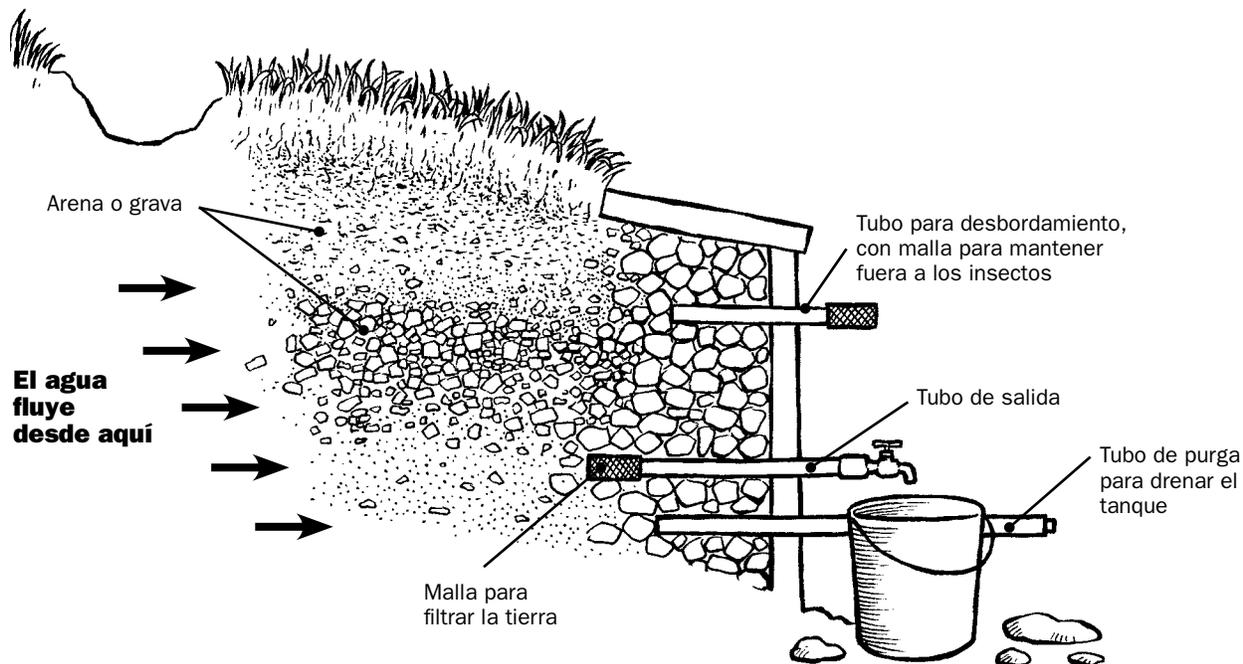
Aquí se ve el tanque de captación sin una cara lateral, para poder observar su interior.
